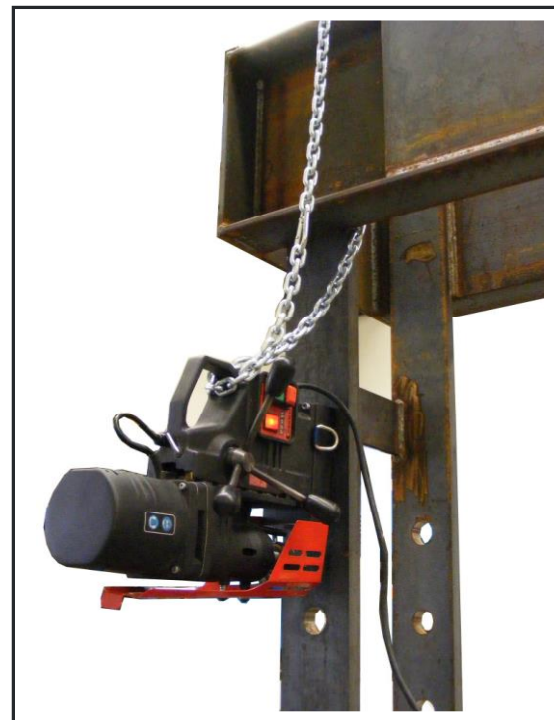
Рис.4 Пример использования страховочной цепи
